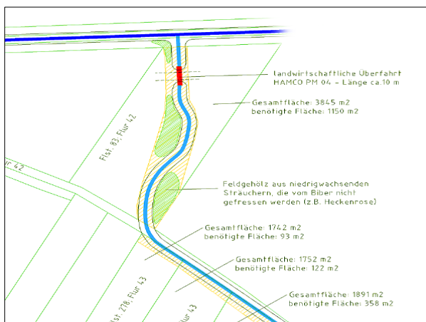
Abb. 2: Prinzipskizze zum Beginn des neuen Gewässerabschnittes im Bereich eines heutigen Ackers. Die Maßnahme ist mit dem Bewirtschafter bereits abgestimmt. (© WLV „Untere Spree“ i.A. der Flächenagentur Brandenburg GmbH)
