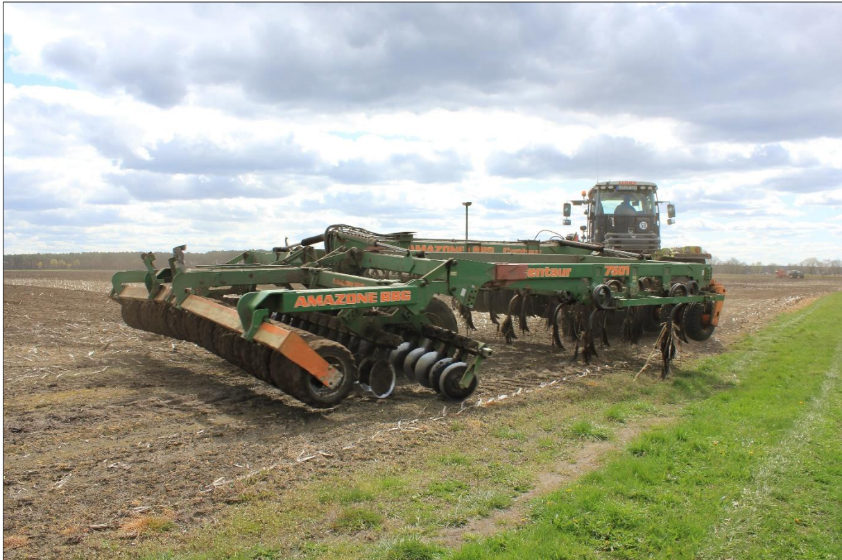
Abb. 3: Saatbettvorbereitung mit Grubber/Scheibenegge/Walze (26.04.2021, Foto A. Schöps)
